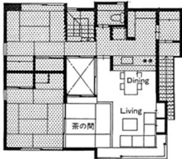
(3)平面図 居間の一部に畳コーナーを設け、茶の間として利用する
