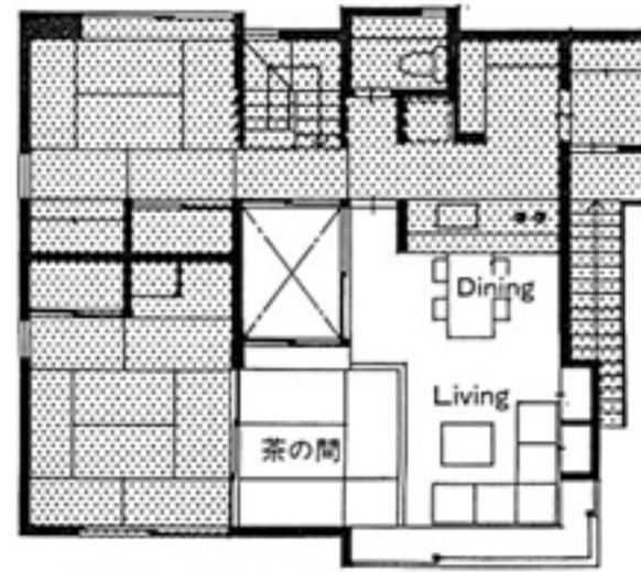
(3)平面図 居間の一部に畳コーナーを設け、茶の間として利用する
