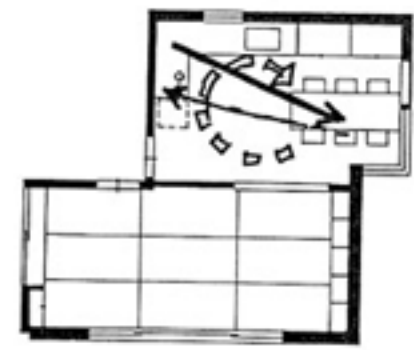
▲④平面図 食堂と台所を一室として考えた動線が短いプラン
