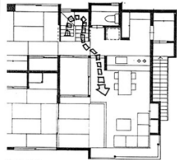
▲④平面図 玄関入ってすぐ居間のある、動線の短い合理的配置
