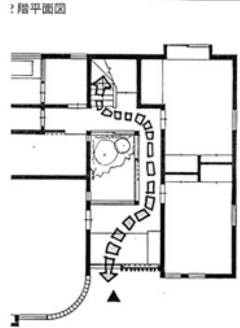
①階平面図 中庭が設けられた動線の長い建築
