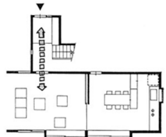
▲④平面図 玄関入ってすぐ居間のある、動線の短い合理的配置
