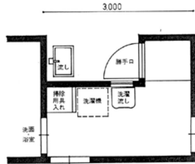
●通路型独立ユーティリティ
